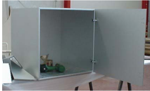
Fig. 3.1.B Conteneur réalisé à l'aide du processus « folding »
