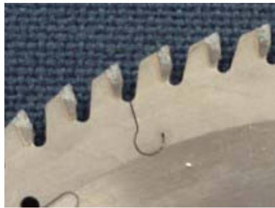
Fig. 2,1 Lame pour aluminium diam. 250 mm, trou 32 mm ; 72 dents ; nb max de tours 8000 ; nb de tours conseillé 3800.
