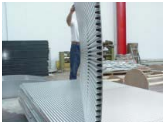
Fig. 3.3.B Doluflex® mono-peau avant de le mettre sur le gabarit
