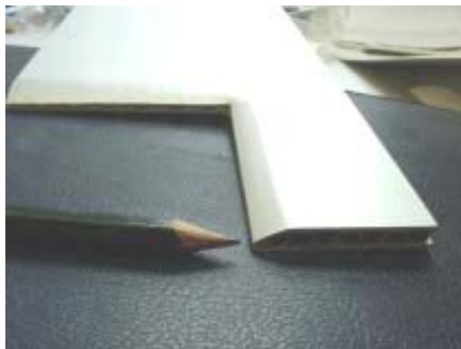
Fig. 2.3 Détail du panneau Doluflex ® coupé avec une scie hydraulique. Comme on peut le voir sur la photo, un seul côté du panneau est légèrement déformé.
