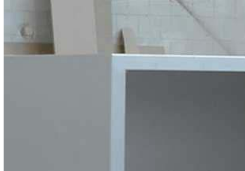
Fig. 3.1.A Élément avec angle réalisé à l'aide du processus « folding »
