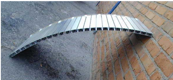
Fig. 3.3.A Élément façonné, obtenu en chambrant le revers
