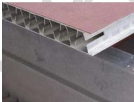
Fig. 2,4 Fraisage latéral pour l'insertion d'un embout « T »
