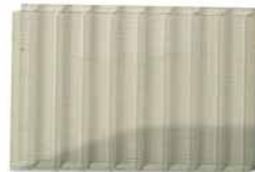
Échantillon 2 - \Delta Y_i = 2 - Garantie des plaques Lexan Thermoclear Plus
