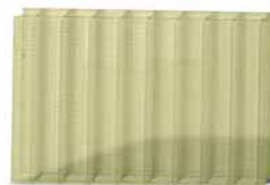
Échantillon 3 - \Delta Y_i = 10 - Garantie classique des plaques PC multi-parois
